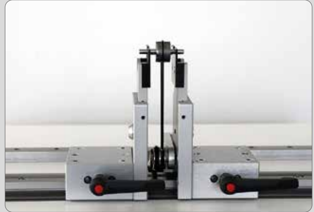
Kleiner Elektroläufer auf Gleitlagerprismen
