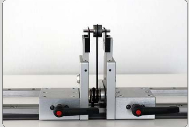
Kleiner Elektroläufer auf Gleitlagerprismen
